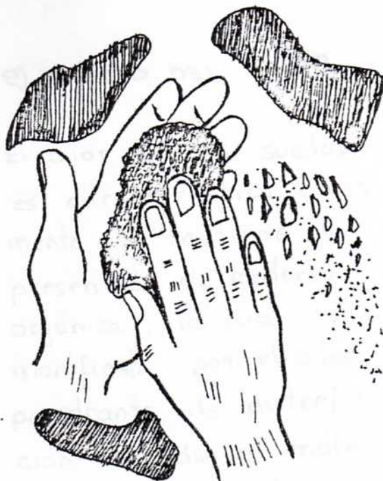
ENSAYO DE ADHERENCIA A LA PIEL
