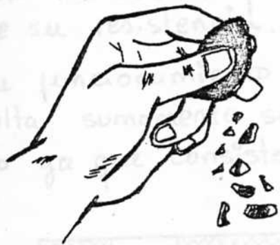
DESMENUZAMIENTO DE LA MUESTRA SECA ENTRE LOS DEDOS.
